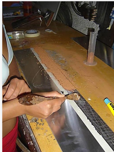
Figura 9. Preparazione della controforma in lamine di alluminio
