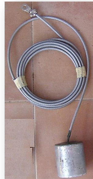
Figura 12. L'anodo di sacrificio con cablaggio in filo di rame rivestito.
