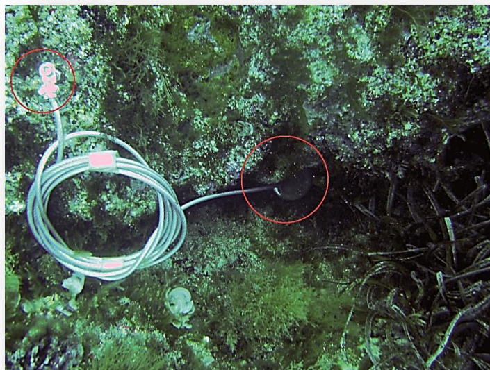
Figura 15. Isola di Marettimo (TP) Cala Spalmatore. Particolare del cannone con il sistema ad espansione costituito da un singolo perno collegato agli anodi mediante un cablaggio in filo di rame rivestito.
